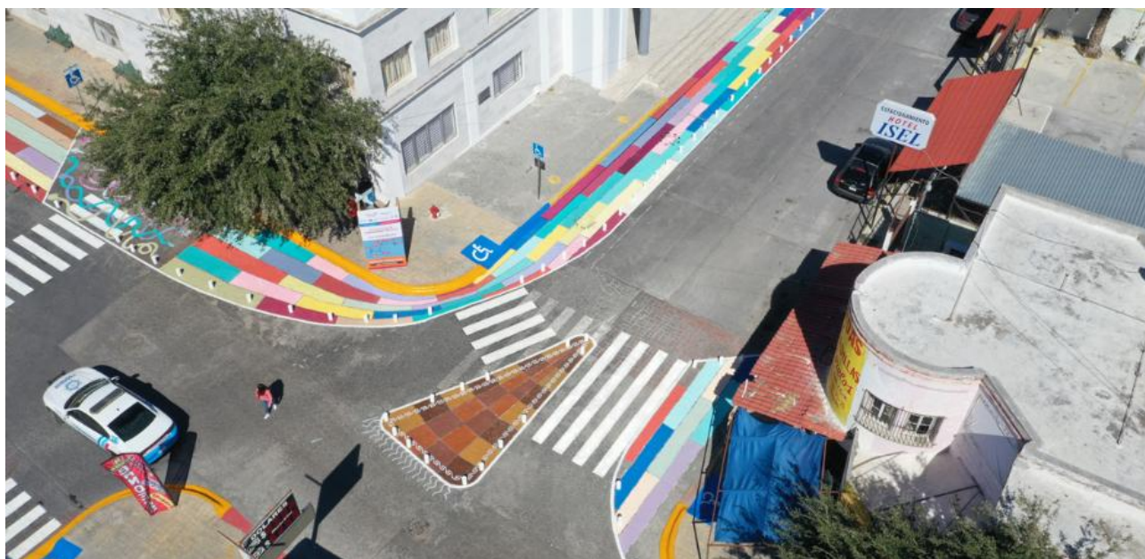
Fig 70. Ampliación de aceras mediante urbanismo táctico. Fuente: ONU-Habitat
