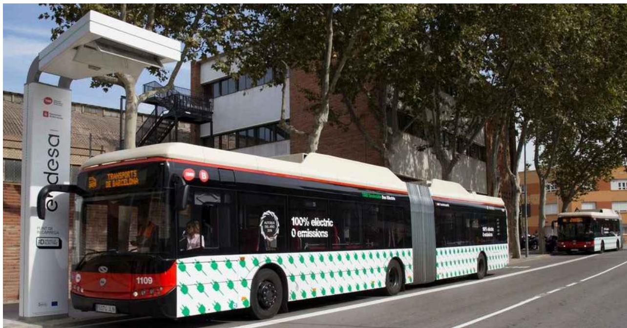
Fig 119. Recarga de autobús con pantógrafo. Fuente: TMB Barcelona
